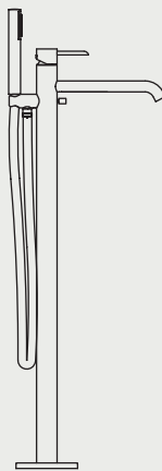
Floor mounted single lever bath shower mixer: Includes hand shower and 150cm shower hose. Automatic diverter. "Plus" aerator. Monomando baño/ducha instalación a pavimento con flexible de 150cm y teleducha. Inversor automático y aireador "plus".
